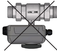
NON INSTALLARE LA VALVOLA CAPOVOLTA
